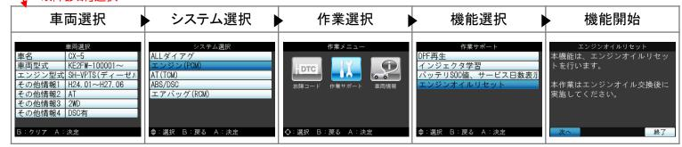
故障コードの確認や、「定期メンテナンス」機能を含む 各作業サポート機能を表示 ⇒詳細の確認、作業が可能
